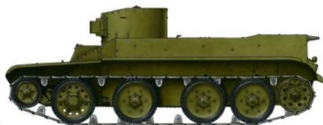
★ БТ-ИС — экспериментальный танк на базе БТ-2 с полным приводом на все колёса, прошедший испытания летом 1935 года.
