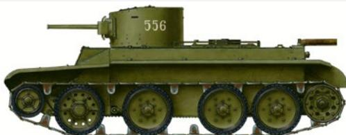
★ БТ-2 с пушечно-пулемётным вооружением и экспериментальным дизелем БД-2, прошедший испытания в конце осени 1933 года.
