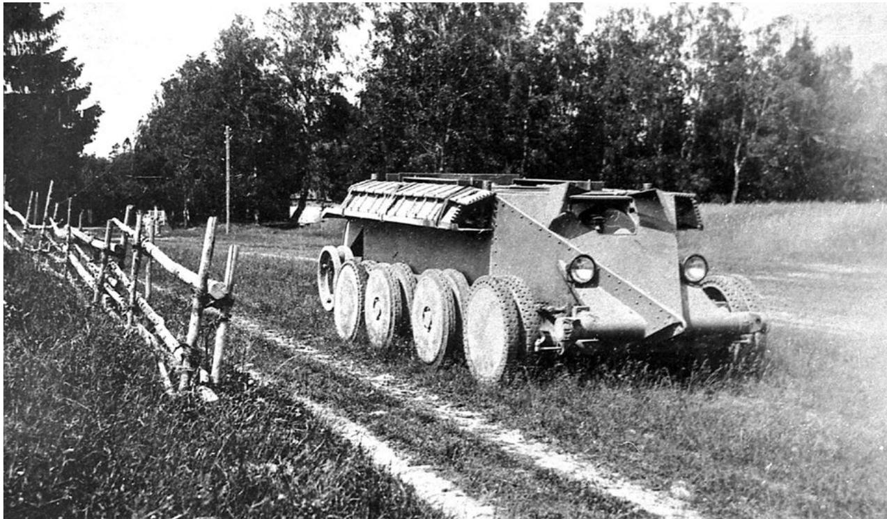
«Оригинал-1» (M1940) на колёсном ходу во время испытаний в СССР летом 1930 года. Гусеницы разобраны на секции и уложены на полках вдоль бортов машины.
